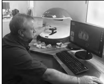
tisfacer todo tipo de necesidades a la hora de diseñar una prótesis implanto soportada. Una de las ventajas más importantes que se obtienen con el **DT2 CNC** es la eliminación del colado y los problemas que conllevan el encerado, embestido, fundido de metal, calce, etc.
