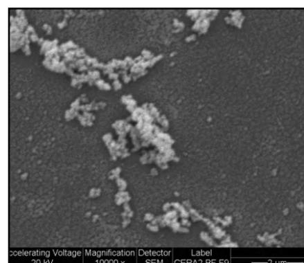
Fig. 2- Microfotografía tomada con Microscopio Electrónico de Barrido de un implante de zirconio con adhesión de microbiota oral. La flecha negra punteada señala la agrupación de cocos orales en racimos.
