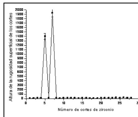
Fig. 1- Registro de la altura de la rugosidad superficial de los cortes de zirconio en  $\mu$ , por MEB. Las curvas ascendentes señalan los valores máximos:
