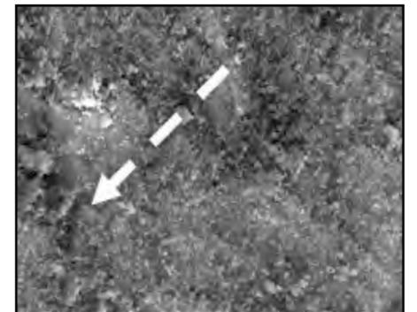
Fig. 2. Microfotografía de un corte de Zirconio observado por MEB. Magnificación 3000 x. La flecha blanca discontinua, indica las irregularidades de la superficie.
